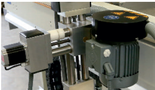
Verstelleinheit der SM-Versionen Automatik und Automatik-Laser. The RKS adjustment/positioning unit for SM Type Automatic and Automatic-Laser function.
