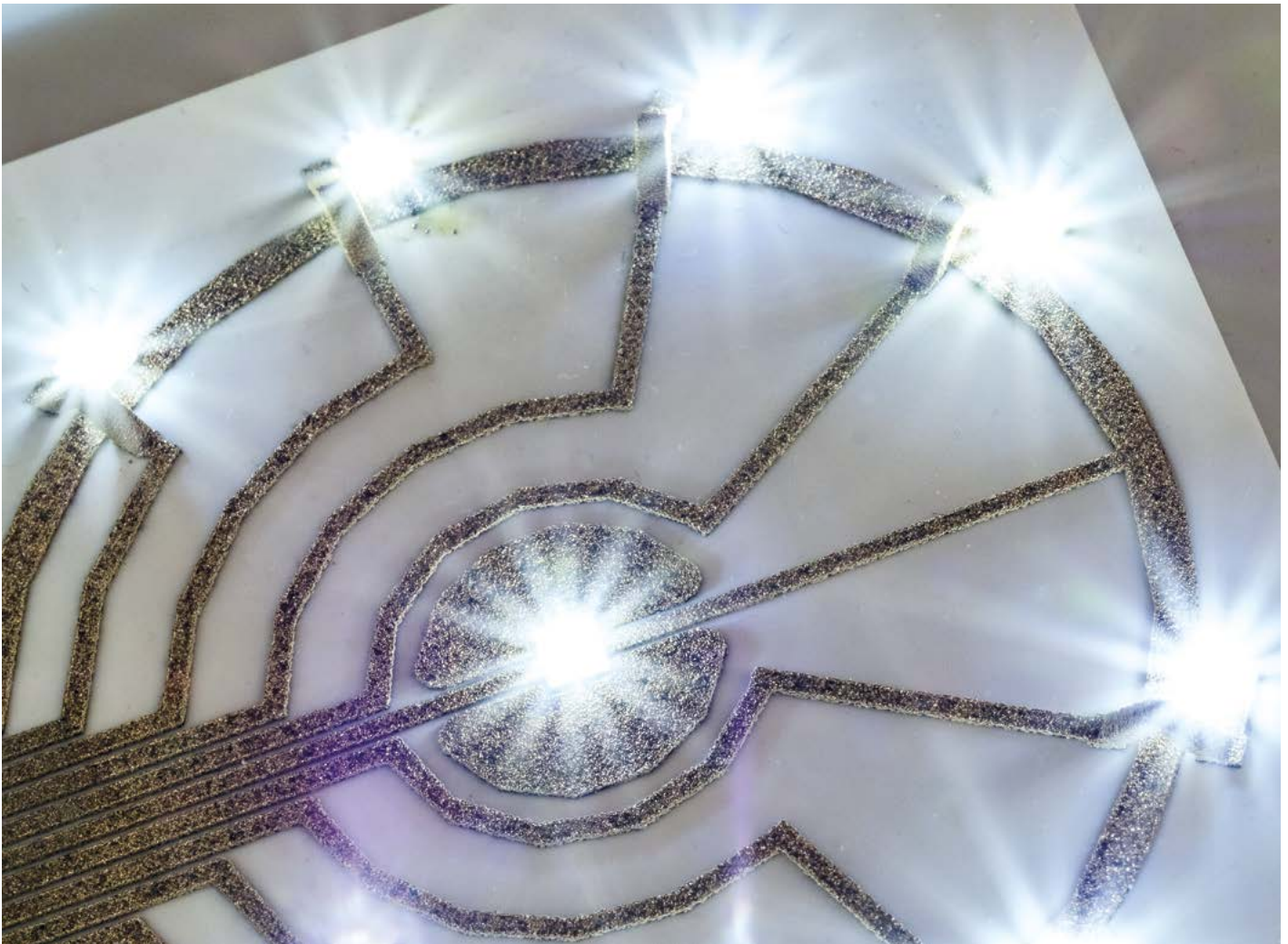
Demonstrator einer mittels SLM aus Bronze hergestellten leistungselektronischen Baugruppe
