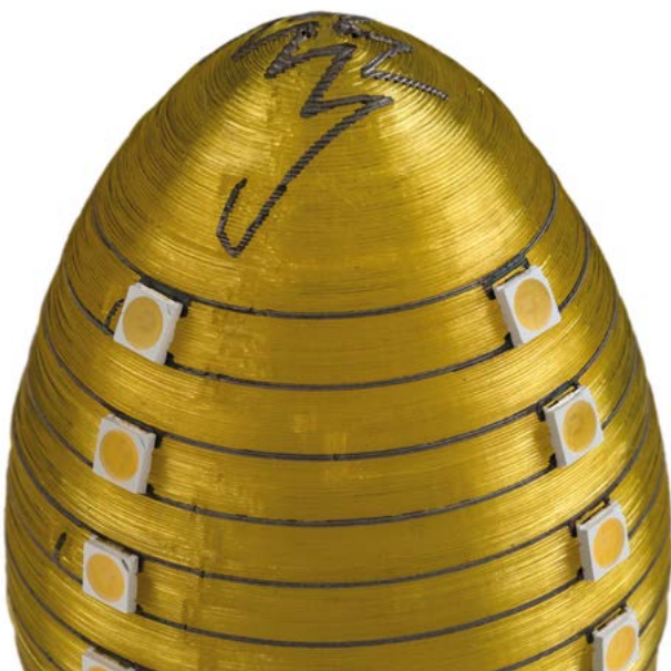
Vollständig additiv in einer Maschine hergestellte Eieruhr Egg timer manufactured completely additive in one machine
